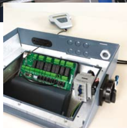
Все электро- и управляющее снаряжение собрано в электрошкаф средней секции агрегата.
