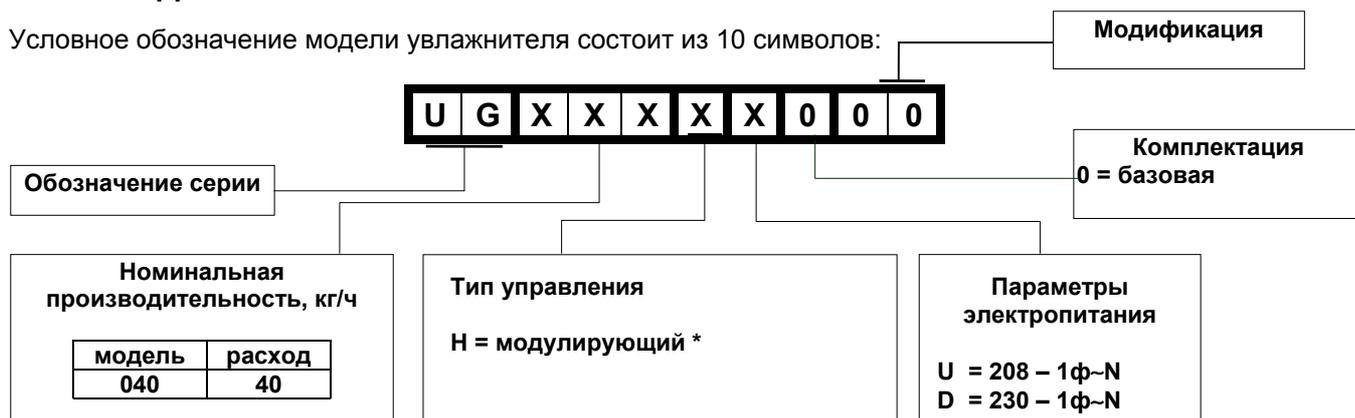
\* Модулирующий тип управления включает: двухпозиционное, пропорциональное управление относительно внешнего управляющего сигнала, с интегрированным управлением по влажности или температуре.
